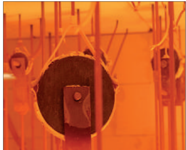
Bild 6.2: Feuerwiderstandsprüfung Rohrschelle / Sikla
