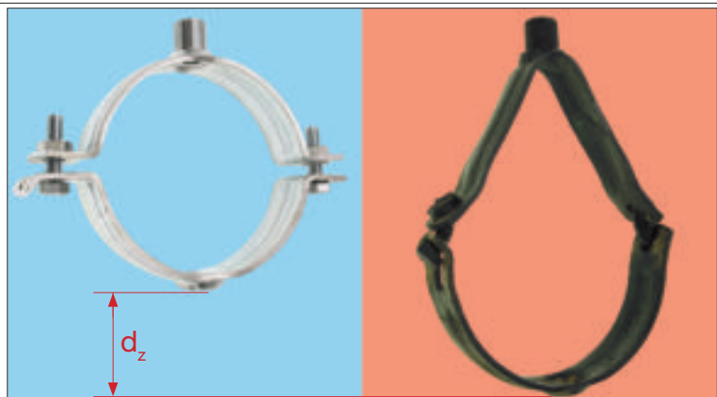
Bild 6.3: Rohrschelle Stabil D-3G vor und nach Brandversuch / Sikla
