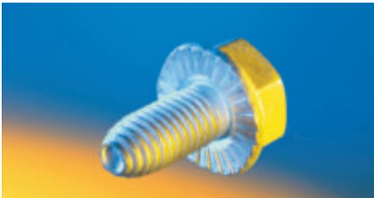
Profil und Anbindeteil werden über gewindeformende Schrauben miteinander verbunden. Durch die spanlose Umformung des Trägerprofils wird eine passgenaue Kaltverfestigung des Muttergewindes erreicht. Aufgrund der Gewindeformung beim Verschrauben entfällt das Aufsetzen und Anziehen einer Kontermutter. Zudem wird mit einem Schraubentyp für alle Bauteile bzw. Einsatzbereiche gearbeitet.
