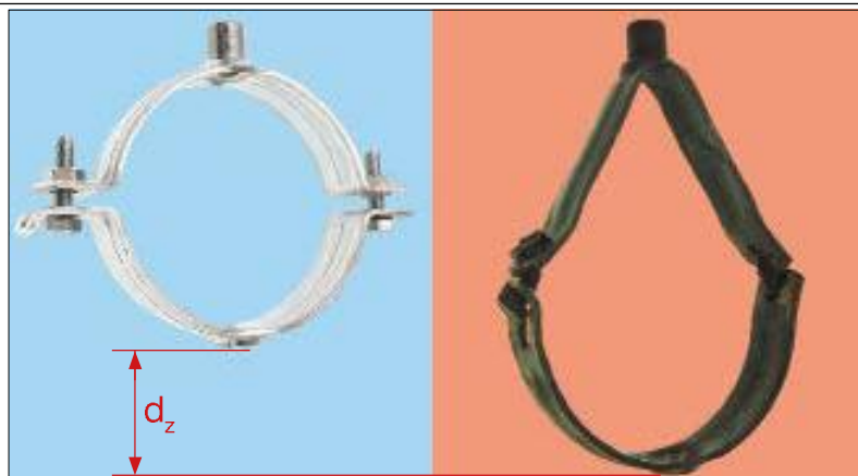
Figura 6.3: abraçadeira de tubos Stabil D-3G antes e depois do teste de fogo/Sikla
