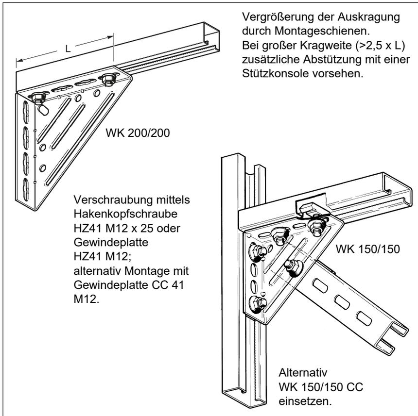
▲ Die Montageschiene wird direkt an der Wand montiert. Damit kann im Vergleich zum vertikalen Schenkel der Winkelkonsole der Achsabstand der Anker und somit die Lastaufnahme vergrößert werden.
